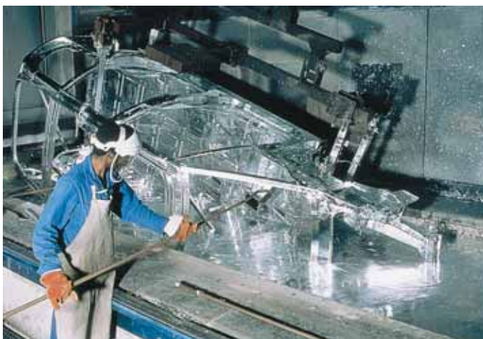
Galvanisation d'une structure automobile
